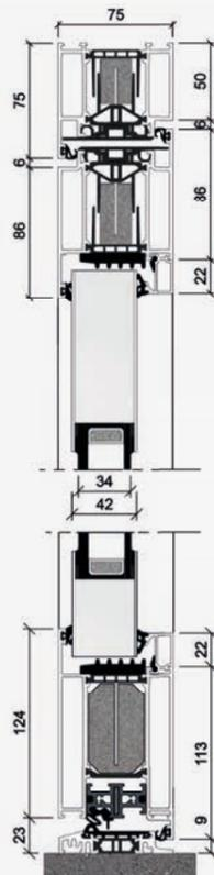
Vertikaler Schnitt zu KÖSTER Advance 75 als Glasfalz. Gezeigt werden die Bodenschwelle und der verstellbare Bodenabschluss, der leichte Toleranzen ausgleicht.
